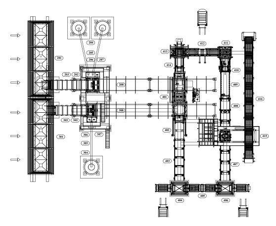
TYPE A - SEMIAUTOMATIC LINE WITH LEGGED PALLET SYSTEM
